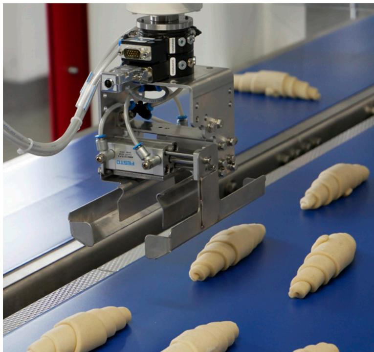
Beim Geschwindigkeitsvergleich der Fanuc-Roboter untereinander sind Delta-Ausführungen nicht zu schlagen. Für die Aufnahme von empfindlichen Croissant-Teiglingen wurde ein spezielles Werkzeug entwickelt.
