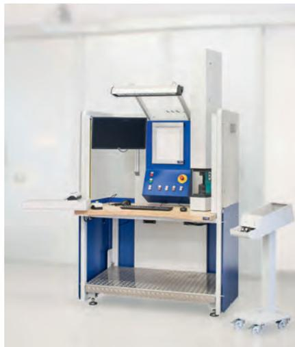
Arbeitssicherheit die entscheidende Rolle spielten. Bei den Montageabläufen legte ASA Wert auf die Aufgabenteilung zwischen manueller Handhabung und Einpressen beziehungsweise Einstellprozessen, die die Qualitätsrelevanz bestimmten. Sämtliche Abläufe wurden von einer SPS gesteuert und überwacht. Eine übergeordnete Steuerung übernahm die Visualisierung und Dokumentati- on der Qualitätskenndaten. as
