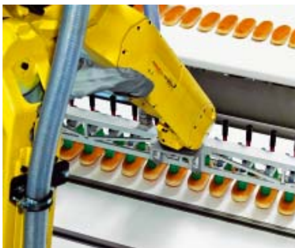
Das Abgreifen der Brötchen übernimmt ein schneller Roboter mit großer Reichweite, ein M-20iA
